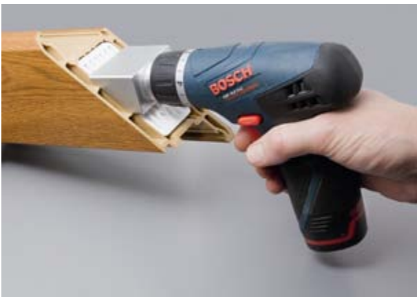
5. Расклинить угловой соединитель скрепить шурупами
