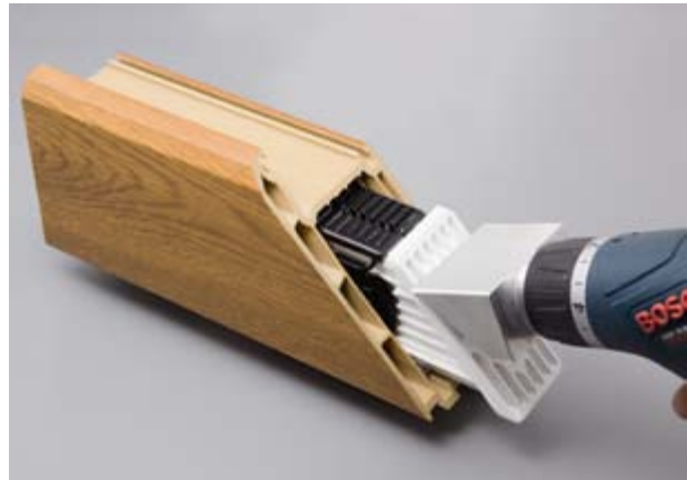
4. установить соединитель так, чтобы он прилегал к усилителю
