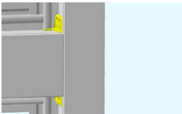
импост установлен горизонтально
