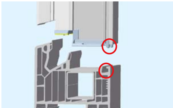
вдвинуть направляющие в паз
